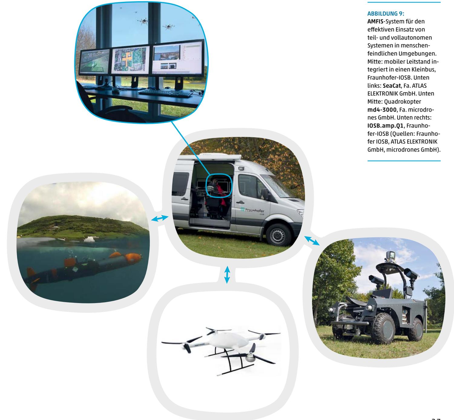
**ABBILDUNG 9:** AMFIS-System für den effektiven Einsatz von teil- und vollautonomen Systemen in menschenfeindlichen Umgebungen. Mitte: mobiler Leitstand integriert in einen Kleinbus, Fraunhofer-IOSB. Unten links: SeaCat, Fa. ATLAS ELEKTRONIK GmbH. Unten Mitte: Quadrocopter md4-3000, Fa. microdrones GmbH. Unten rechts: IOSB.amp.Q1, Fraunhofer-IOSB (Quellen: Fraunhofer IOSB, ATLAS ELEKTRONIK GmbH, microdrones GmbH).
