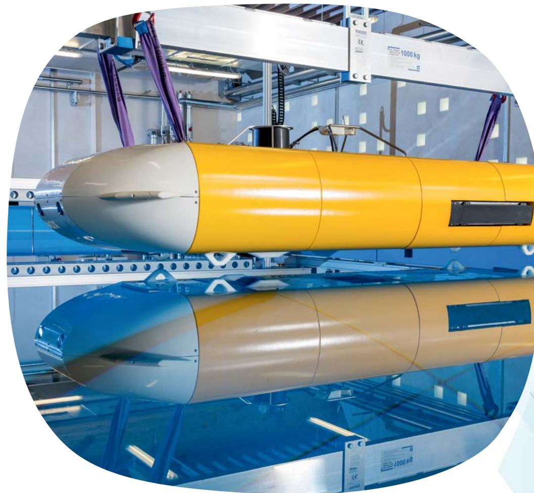
**ABBILDUNG 8:** DEDAVE im Unterwasserlabor am IOSB-AST in Ilmenau (Quelle: Fraunhofer IOSB). Modularer Aufbau, Tauchtiefe bis 6.000 Meter, L x B x H = 3,5 Meter x 1,25 Meter x 0,55 Meter, Gewicht inklusive Nutzlast: 750 Kilogramm, Tauchdauer bis zu 20 Stunden, Geschwindigkeit: 4 Knoten, Energieversorgung: Schnellwechsel-Li-Polymer-Modul mit 10 Kilowattstunden.
